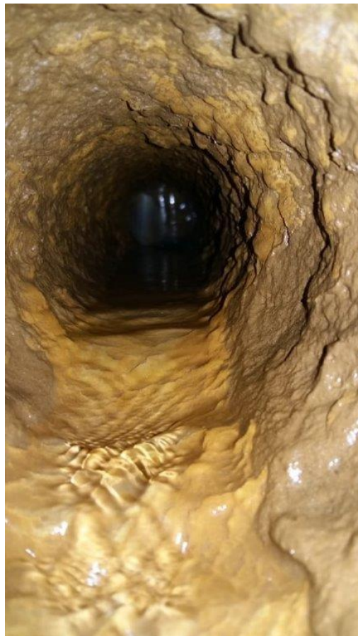
Foto 2 - Incrustações do Sistema de Água Industrial e de Resfriamento da Unidade Geradora
